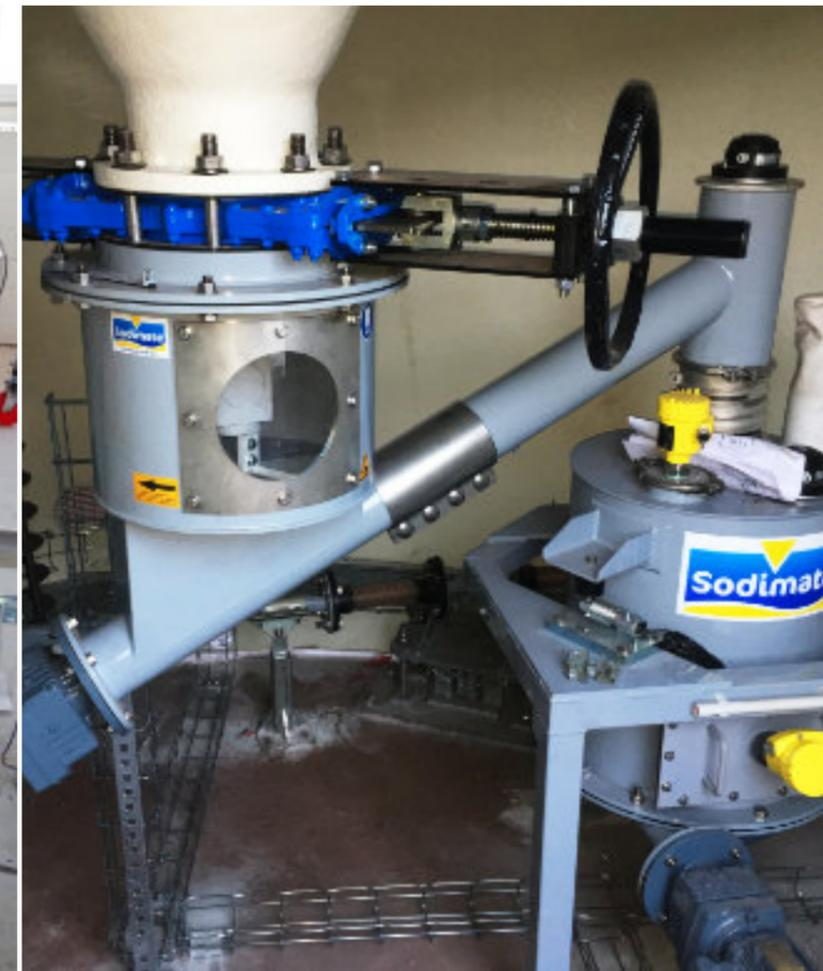
Bei den Förderschnecken DMR handelt es sich um Rohrschnecken mit einer einseitig gelagerten Spirale. Sie werden einer Dosierschnecke nachgeschaltet und fördern das dosierte Produkt dann zur Beschickungsstelle, ohne die Dosiermenge zu beeinflussen.
