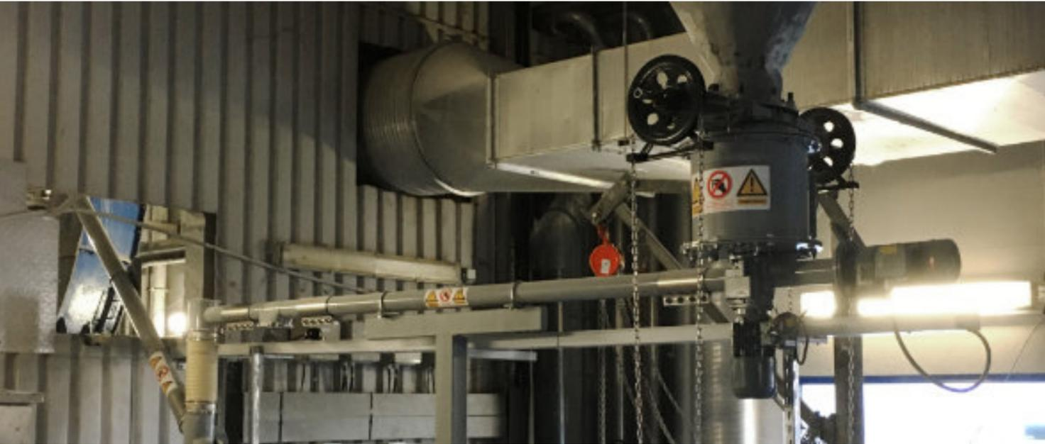
Die Sodimate-Förderschnecken funktionieren nach dem "Baukasten-Prinzip" und sind äußerst variabel einsetzbar:
