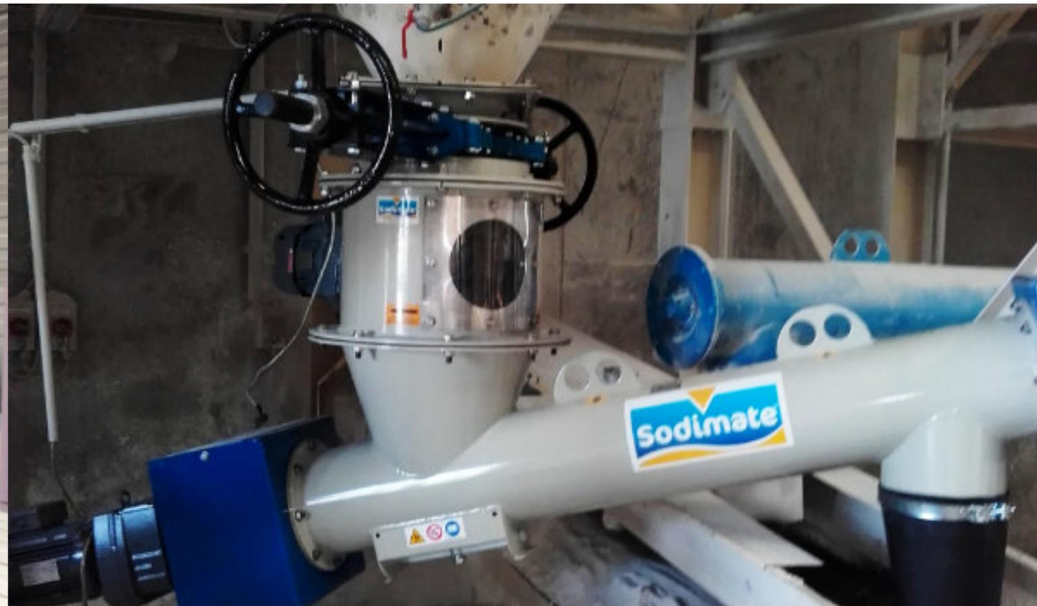
**Austrags- und Dosiereinheiten unter zylindrisch-konischen Silos und Lagerbehältern**
