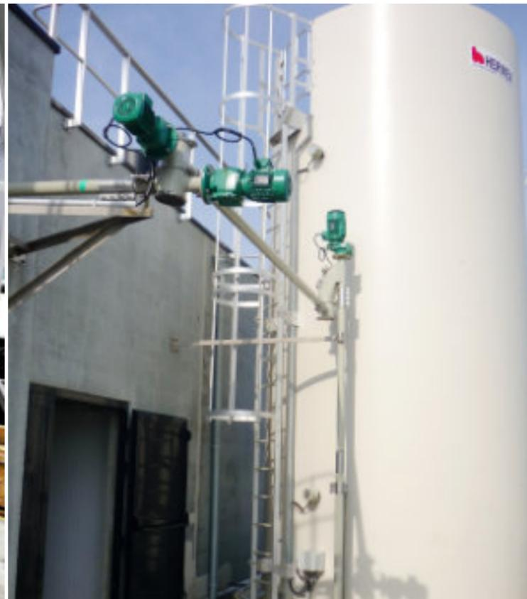
Der Injektor ID kommt überall dort zum Einsatz, wo pulverförmige Schüttgüter mit hygroskopischen Eigenschaften mit Flüssigkeiten oder einer feuchten Umgebung in Verbindung kommen.
