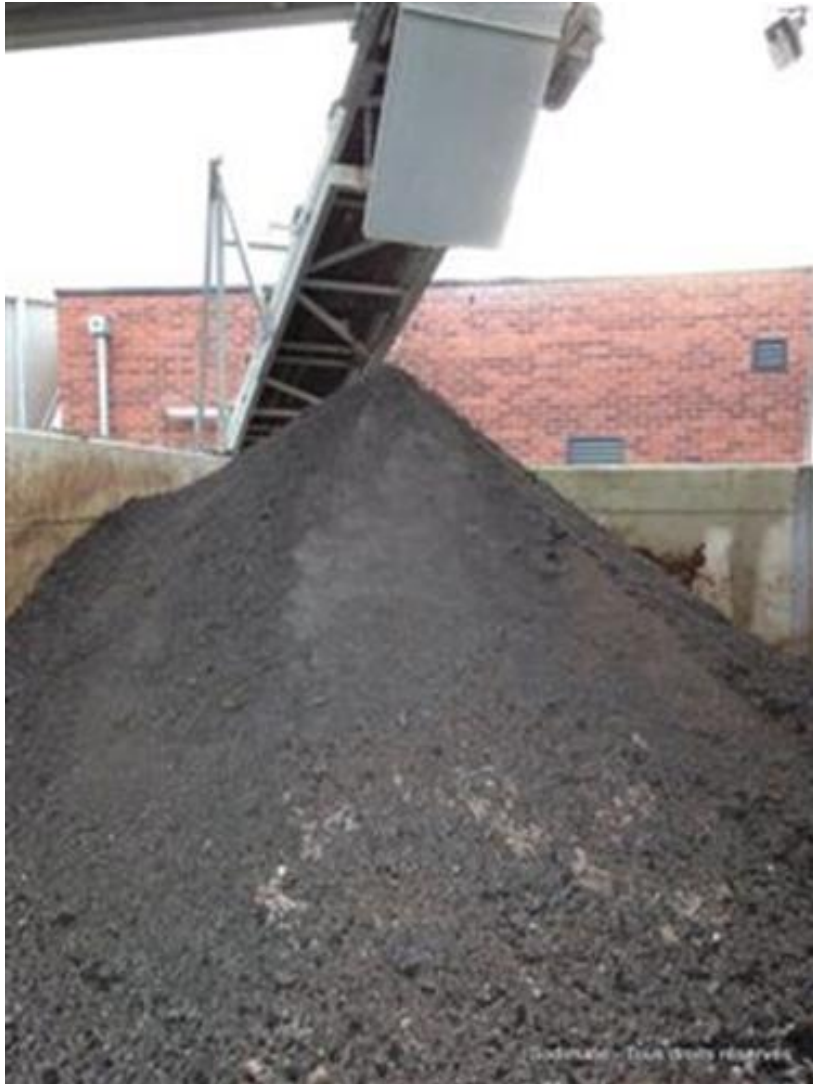
Stabilisierter, gekalkter Schlamm
