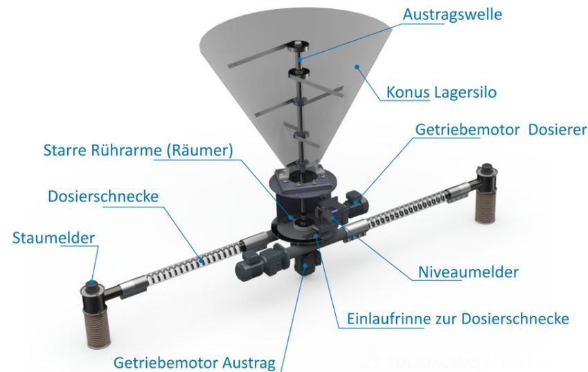
Auf der Austragswelle befinden sich auf 5 Ebenen (ZDM 400 / ZCD 800) bzw. auf 3 Ebenen (ZFP 400 / 800) flexible Metallfedern aus Edelstahl, die an einer Nabe befestigt sind. Diese Metallfedern sind vorgespannt und bleiben um die Nabe herum gewickelt, solange das Produkt gut fließt. Dabei wird der zentrische Austrag des Produktes durch die Rotation der Austragswelle unterstützt.
