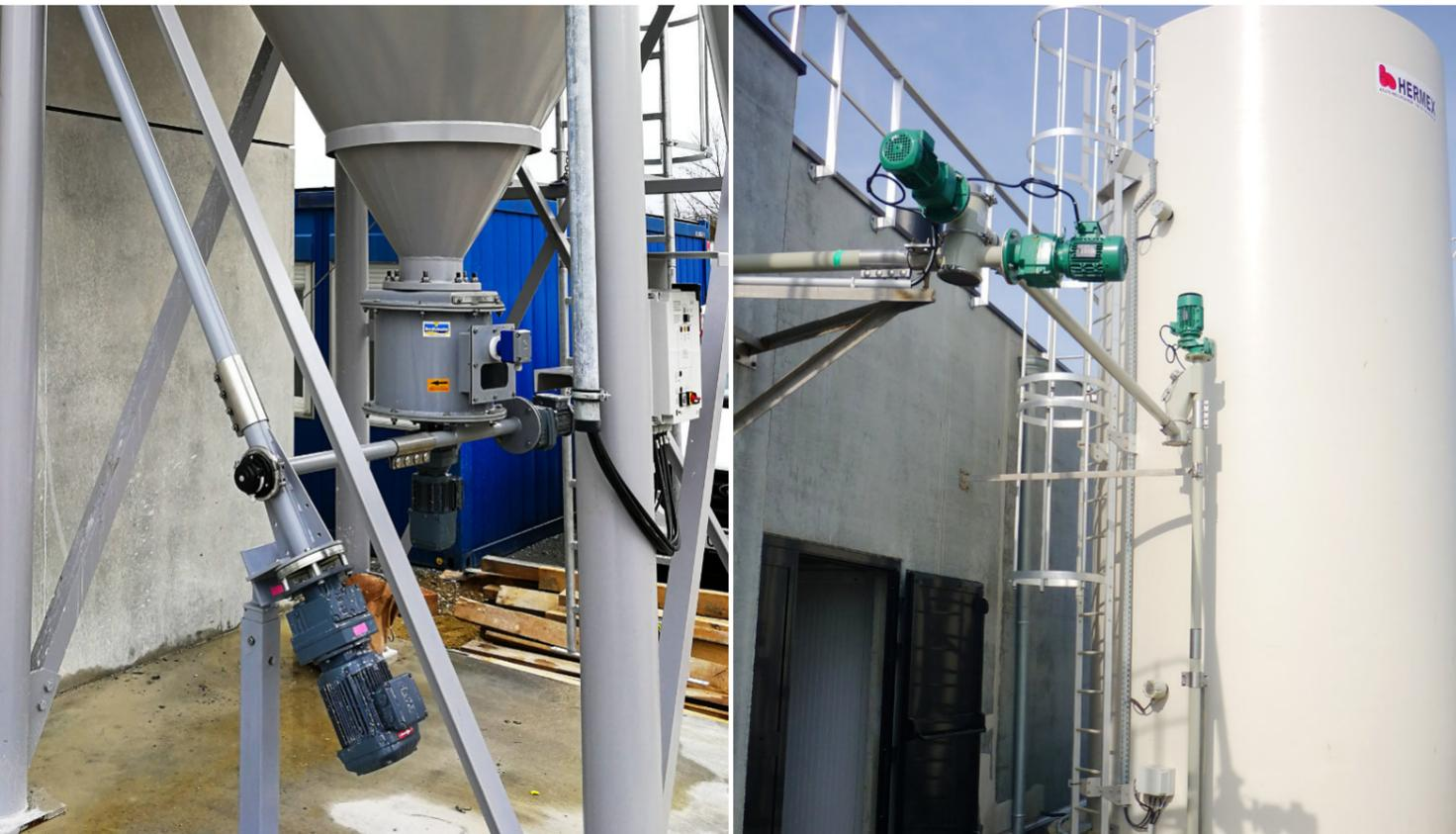
Der Injektor ID kommt überall dort zum Einsatz, wo pulverförmige Schüttgüter mit hygroskopischen Eigenschaften mit Flüssigkeiten oder einer feuchten Umgebung in Verbindung kommen.
