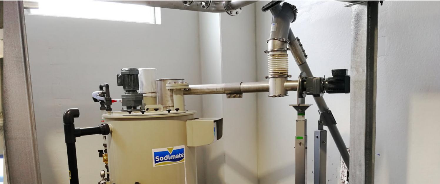
Bei den Sodimate-Anlagen wird er systematisch zwischen den Dosier- bzw. Förderschnecken und Ansetzbehältern, Kalklöchanlagen, Schlammförderschnecken sowie Doppelwellenpaddelmischern zur Schlammkalkung eingesetzt.
